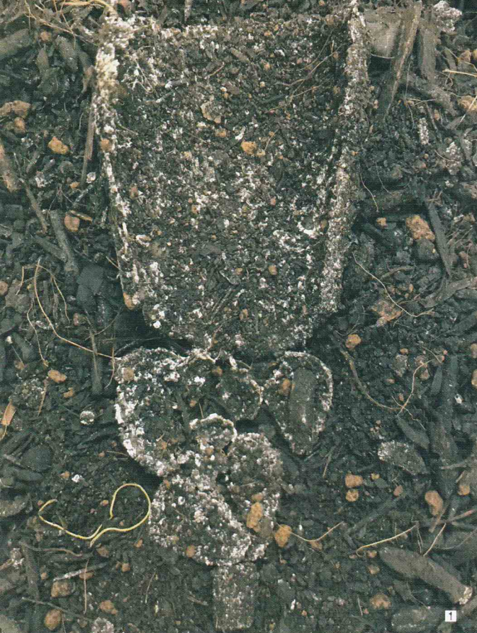
1 自然に戻る生分解性樹脂のグラス。製品によって異なるが、一定条件下であれば数カ月で分解される 2 N-PLAjetで作られる製品の一例。多様なジャンルへの展開が可能 3 「機械を製造し売るだけでなく、納品してからもお客様に対してどのようなメリットを提供できるかを常に考えています」と依田さん 4 日精樹脂工業の技術が凝縮したN-PLAjet 5 70年ほど前に誕生した販売第一号機。大きく進化しているが基本原理は変わっていない
