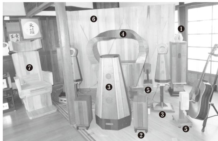
⑤はタツチサウンドスピーカーで、前面のバーが音楽信号で振動し、このバーを板や箱に当てる
